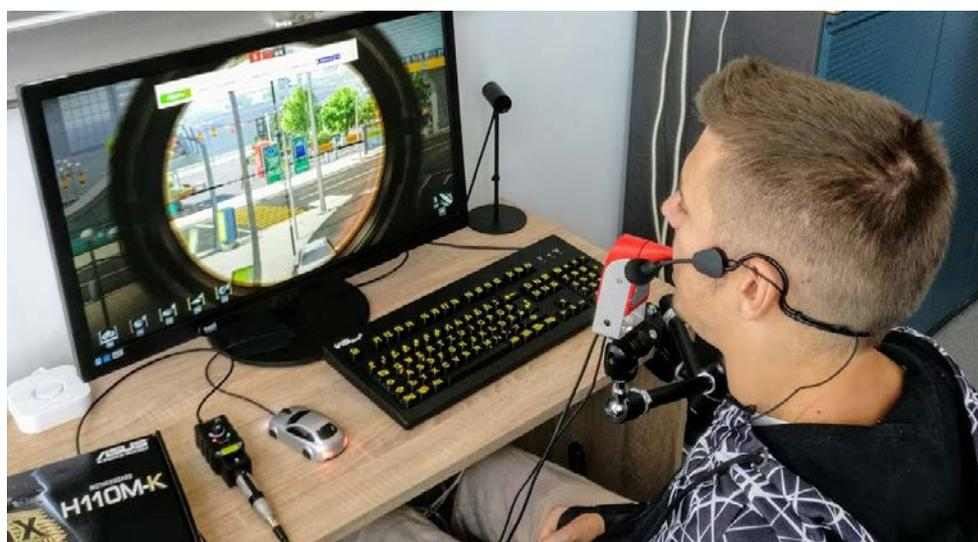
Abbildung 7: Testbenutzer bei der Interaktion während eines Computerspiels mittels Sprache und Mundmaus. © LIFEtool
