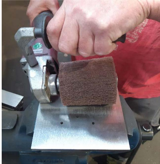
Die Oberfläche der Metallteile wird gebürstet.
