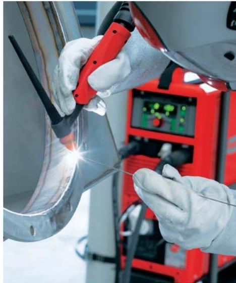
Abbildung 2: Industrieller Schweißer während eines WIG-Schweißvorganges © Fronius
