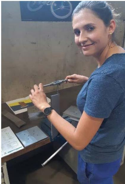
Mitarbeiterin schneidet mit dem Handgewindebohrer Löcher in die Metallplatte.
