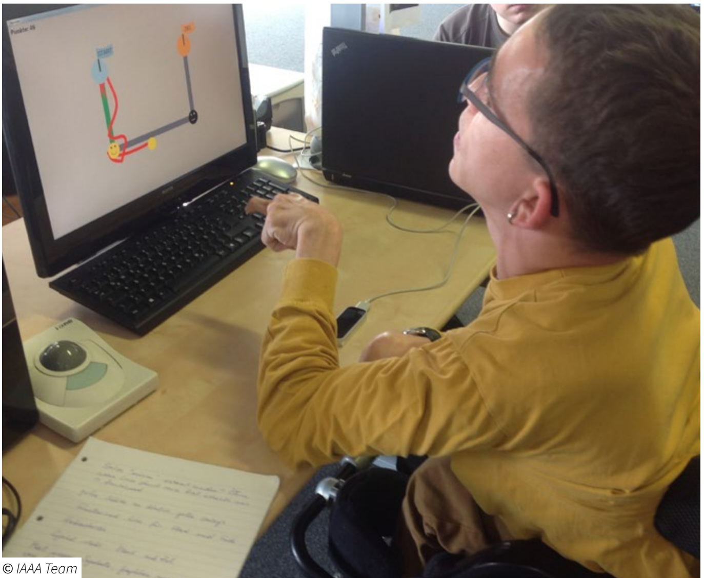
Abbildung 3. Berührungslose Interaktion mit dem Leap Motion Controller, DrawLine Test.
