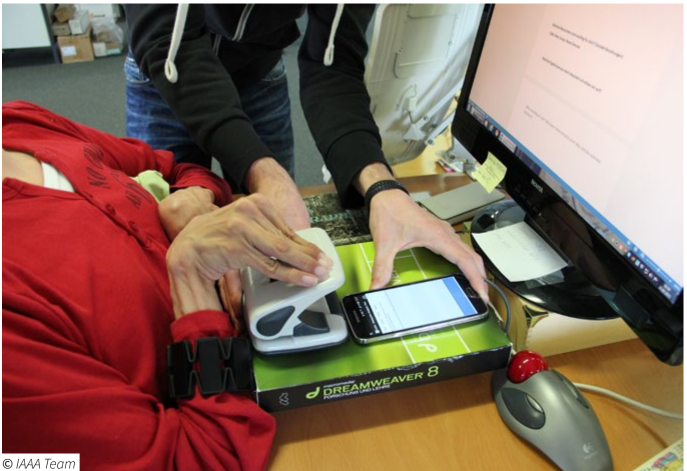
Abbildung 5. Der Locher als Bedienelement für den Magnetfeld-basierten Druckanalyseansatz.
