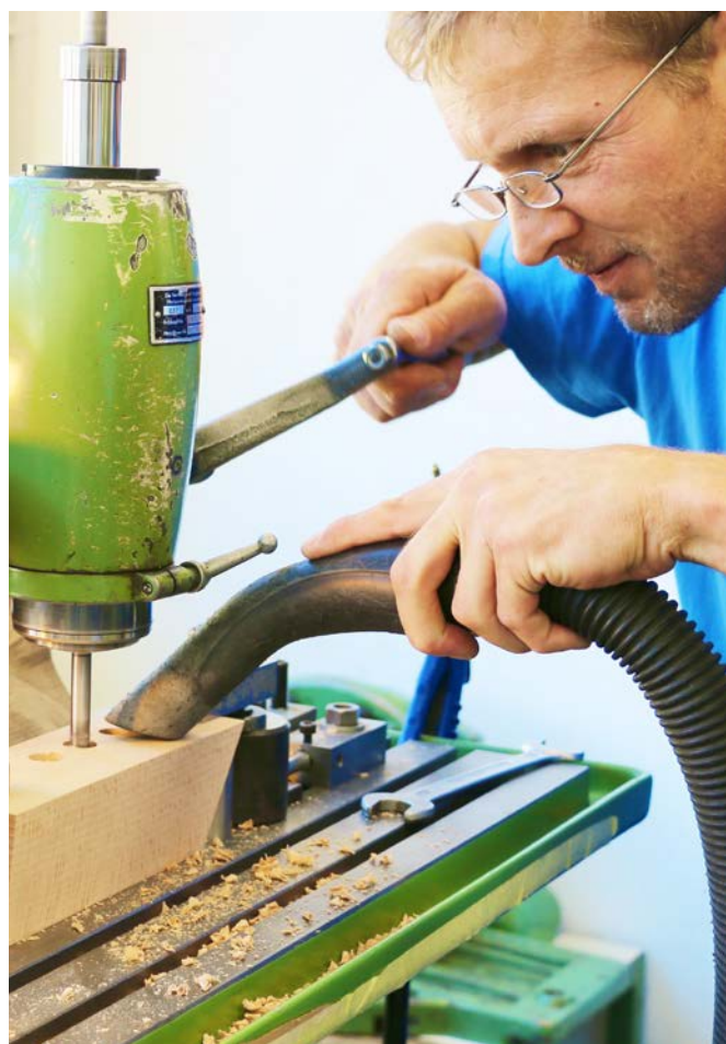
Bildbeschreibung: Bohrungen für die indirekte LED-Beleuchtung © GWS
