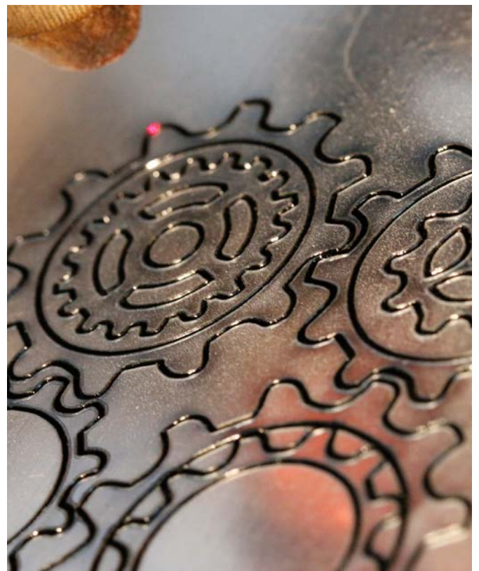
Bildbeschreibung: Laserschneiden der Metalleffektfolie © GWS
