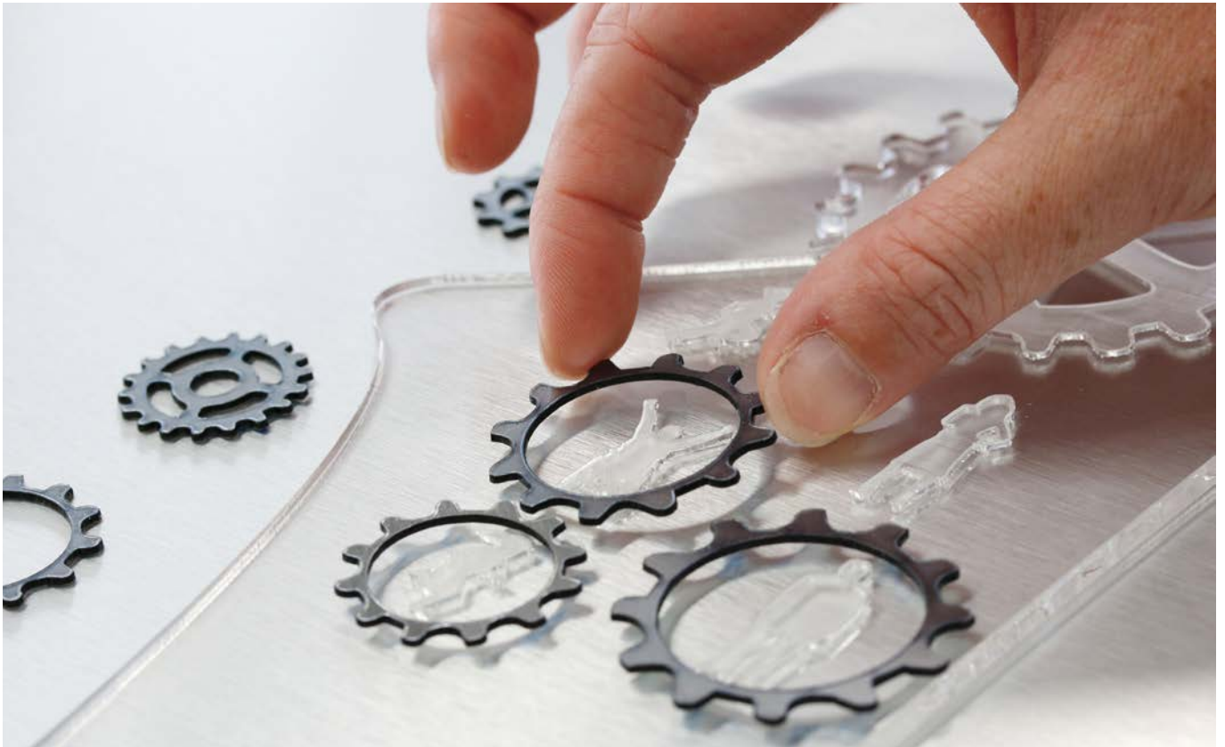
Bildbeschreibung: Aufkleben der Metalleffektkomponenten © GWS
