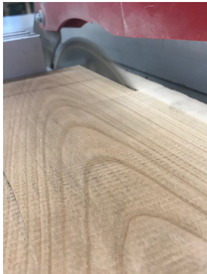
Zuschneiden des Grundkörpers aus dem Eichenbrett © TEAMwork
