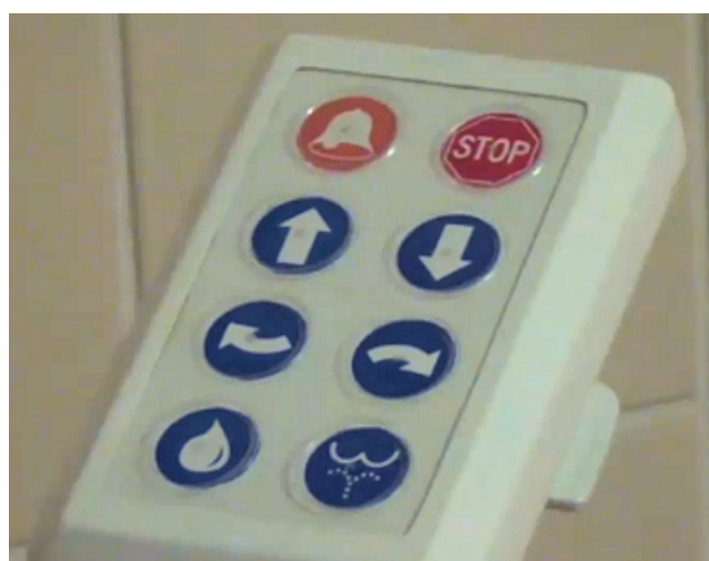
Abbildung 4: Eine neue Handsteuerung mit größeren Tasten und taktilem Feedback, war ein Resultat des partizipativen Designs © iToilet-Konsortium
