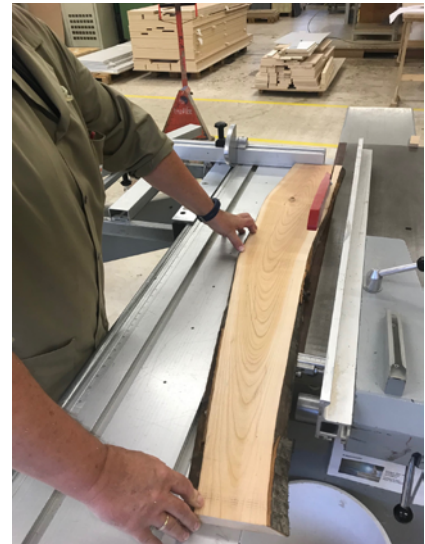
Zuschneiden des Grundkörpers aus dem Eichenbrett © TEAMwork
